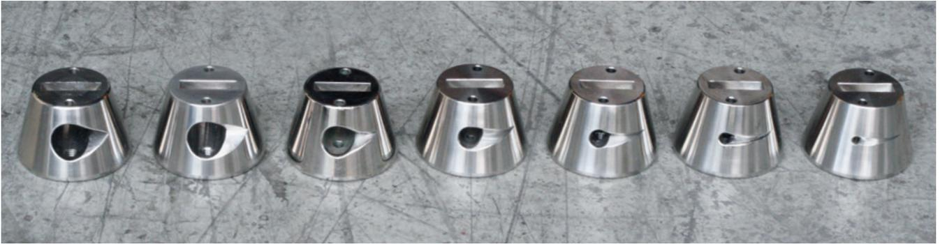
Kleine Blockventile eignen sich auch besonders für die Ausstattung mit Regelglocken für geringste Durchflüsse. Durch feinste Bearbeitung der Regelschlitze in Verbindung mit einem zweistufigen Druckabbau lassen sich kleinste KV-Werte mit einer guten Auflösung regeln.
